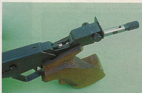
Vue supérieure du pistolet permettant d'observer le couloir d'alimentation dans lequel sont introduits 5 plombs diabolo à la suite les uns des autres.
