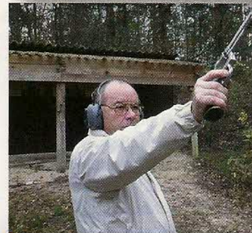
Le poids de ce revolver en acier inoxydable massif, ainsi que la répartition des masses conditionnée par le canon lourd concourent à maintenir le recul et le relèvement dans des limites raisonnables.
