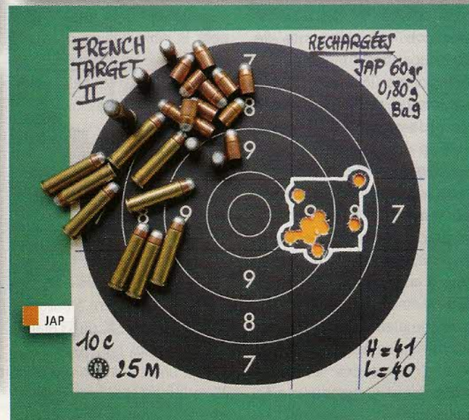
Nos groupements de dix coups, réalisés sur appui à la distance de 25 mètres, démontrent la précision très convenable de ce revolver à canon de 5 pouces.
