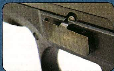
Le démontage sommaire s'effectue au moyen d'une clé transversale dont on chasse l'axe du côté droit vers le côté gauche de la carcasse. La large tête plate dont il est doté facilite grandement sa préhension.
