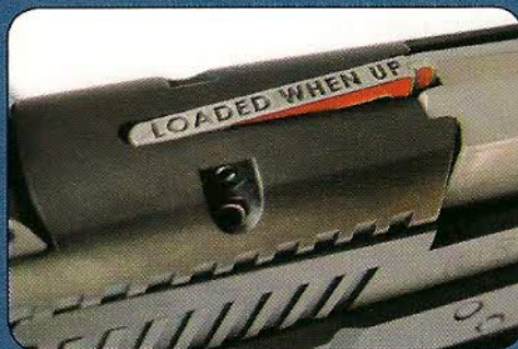
Avec son marquage ostentatoire et ses flancs peints en rouge, le témoin de chargement du SR9 est un modèle de lisibilité.
