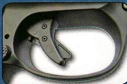
La queue de détente comporte en son centre une pédale de sécurité qui en assure mécaniquement le blocage tant qu'elle n'est pas effacée par l'index du tireur.
