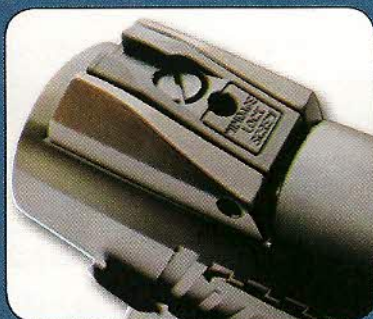
Le réglage en site s'effectue directement, au moyen d'un tournevis, tandis que le pré-réglage en azimut nécessite le déplacement latéral du pied de hausse, après avoir desserré la vis qui en assure le blocage.
