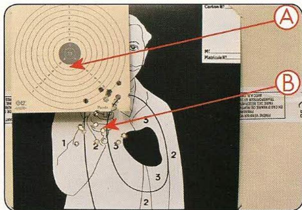
Le centre moyen des impacts (B) se plaçant environ 10 cm au-dessous et 5 cm à droite du point visé à la distance de 25 mètres, nous appliquerons pour cet essai le principe de la contre-cible : la prise de visée est effectuée au bas du visuel de la cible scolaire (A).
