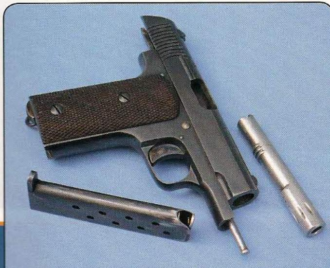
**Le canon, maintenu sur la carcasse par un système à baïonnette composé de trois tenons, peut être extrait instantanément et sans outil, en prenant appui sur ses cannelures antidérapantes pour le faire pivoter d'un peu moins d'un demi-tour (en sens horaire).**
