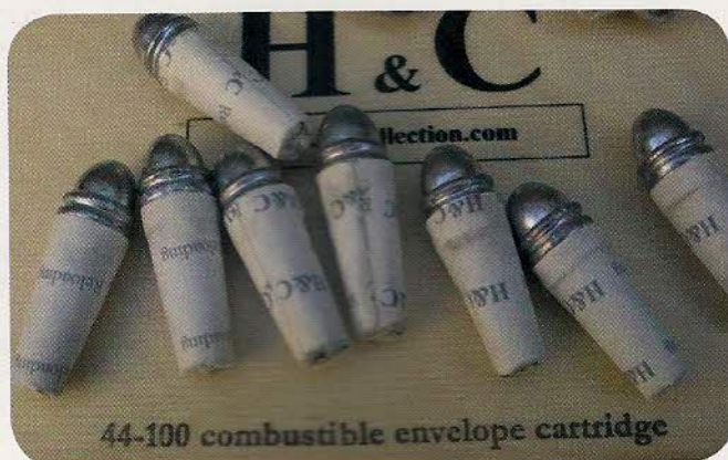
Quelques cartouches combustibles, réalisées par nos soins avec le papier nitré et les balles ogivales fournies par H&C.
