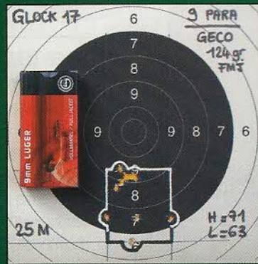
Groupements de 10 coups, réalisés sur appui à la distance de 25 mètres avec le Glock 17, en utilisant exclusivement des munitions manufacturées.
