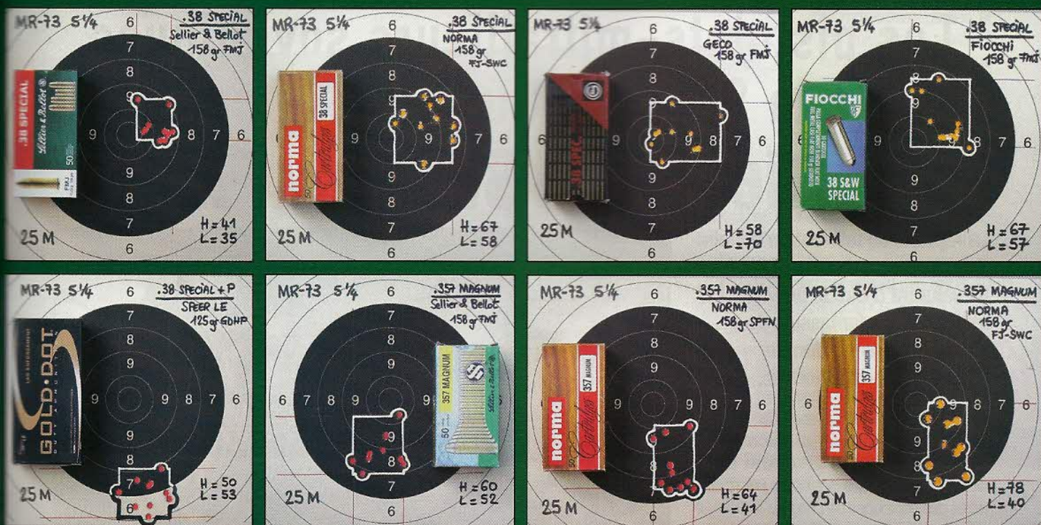
Groupements de 10 coups, réalisés sur appui à la distance de 25 mètres avec le MR-73, en utilisant exclusivement des munitions manufacturées.
