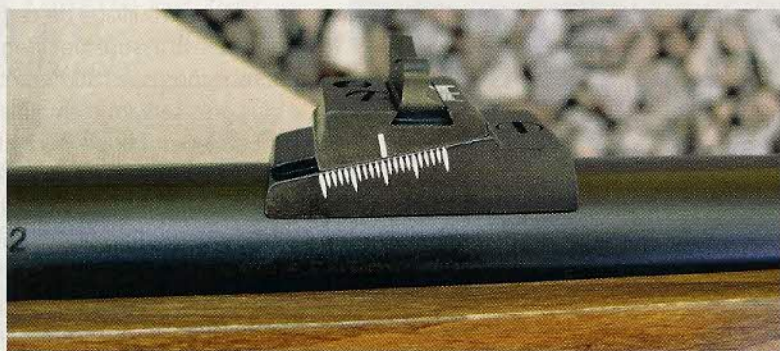
La CZ 455 est munie d'une hausse à rampe, de type chasse, dont les réglages en site et en azimut sont repérés par de fines graduations peintes en blanc.
