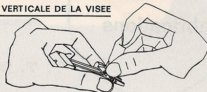
3° Visser ou dévisser la vis d'appui (1 tour correspond à un déplacement de tir de 3 cm à 50 m).
