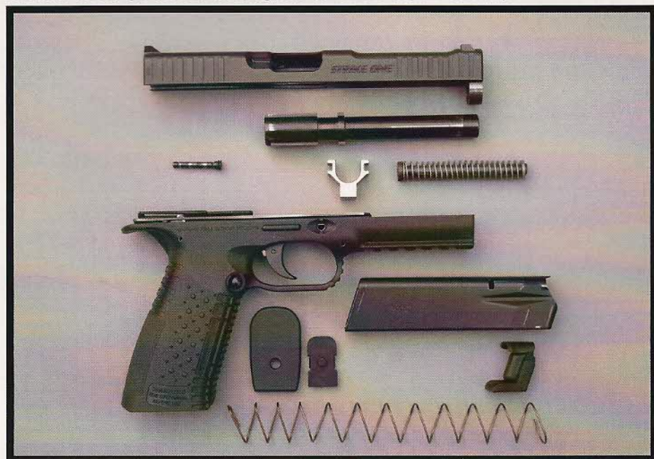
Cette vue de l'arme sommairement démontée permet d'observer le verrou, en forme d'étrier, qui assure le calage du canon au départ du coup.
