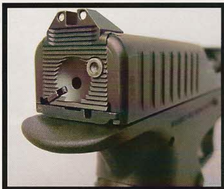
Quand le mécanisme est armé, l'extrémité arrière du percuteur apparaît au centre d'un hémisphère concave, creusé dans la plaque de fermeture de la culasse, assurant ainsi une fonction d'indicateur visuel et tactile.
