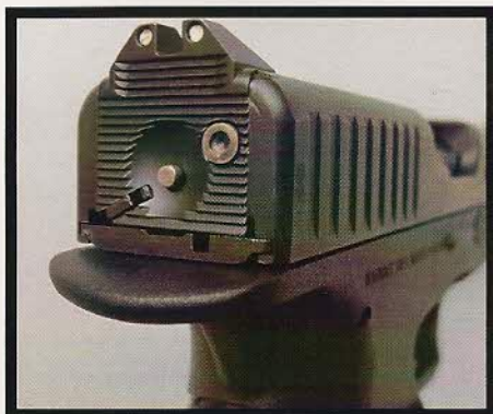
Quand le mécanisme est armé, l'extrémité arrière du percuteur apparaît au centre d'un hémisphère concave, creusé dans la plaque de fermeture de la culasse, assurant ainsi une fonction d'indicateur visuel et tactile.
