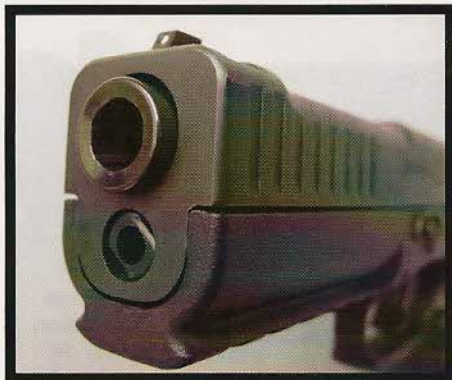
Le canon, dont on notera au passage la confortable épaisseur des parois, présente six rayures dextrogyres au profil traditionnel.
