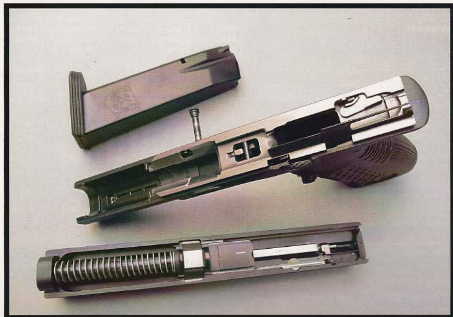
Le démontage sommaire s'effectue instantanément, sans outil, après avoir repoussé l'axe transversal imperdable qui contraint le verrou à s'abaisser au moment du recul et fait accessoirement office de clé de démontage. On notera la très grande longueur des rails de guidage de la glissière.
