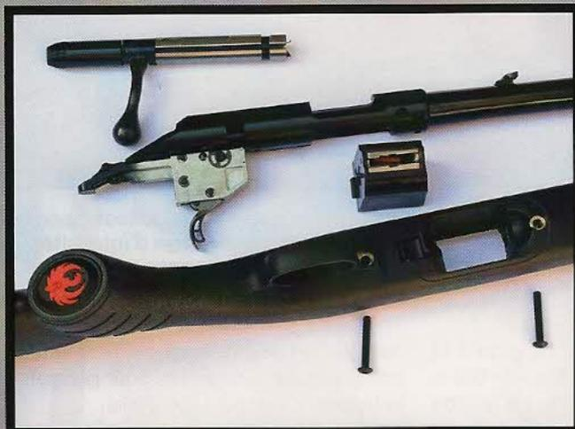
Il suffit de desserrer ses deux vis de fixation pour désolidariser le boîtier de culasse de la monture en polymère. On notera la présence de bagues métalliques noyées dans le fût afin de permettre un serrage vigoureux sans risque d'écraser le matériau synthétique.
