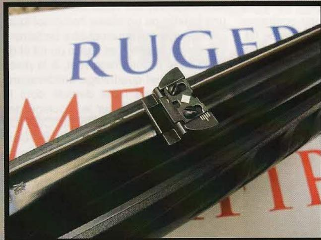
Sa hausse rabattable, dont le pied est installé à queue d'aronde sur le canon, dispose d'un feuillet réversible qui offre le choix entre deux crans de mire et autorise un réglage en site de la visée.
