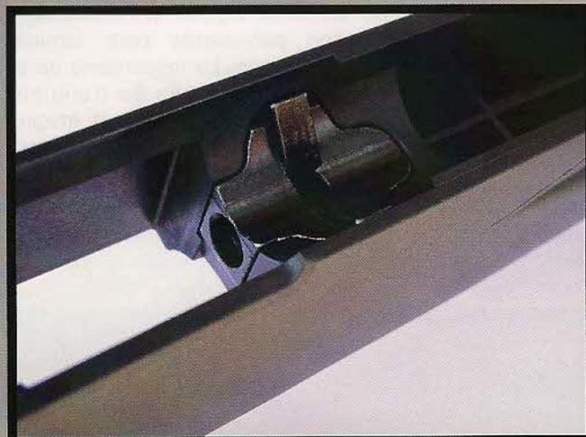
Le bloc métallique antérieur contribue au « bedding » du boîtier de culasse afin d'assurer son assise et laisser le canon flotter librement. Notez les deux tenons en V qui servent de butées anti-recul.
