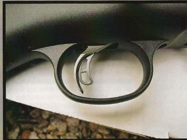
Baptisée « Marksman Adjustable Trigger », sa détente réglable incorpore une pédale de sécurité inspirée par celle du Glock 17.
