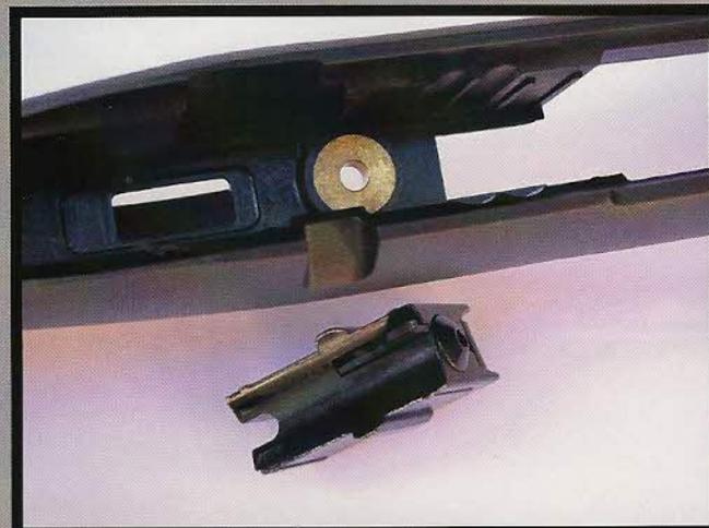
C'est sur ce bloc métallique, auquel est fixé l'éjecteur, que repose la partie postérieure du boîtier de culasse.
