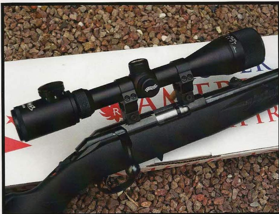
La lunette Walther ZF 3-9x40 dont nous avons équipé notre arme de test dispose d'une bague de réglage de la parallaxe et d'une tourelle de réglage d'intensité de son croisillon lumineux. On notera que la hausse a pu être conservée, du fait qu'elle est rabattable.
