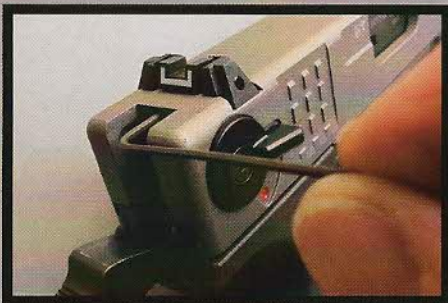
Le pied de la hausse, qui peut être déplacé latéralement sur la glissière grâce à son montage à queue d'aronde, est bloqué au moyen d'une vis.
