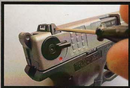
Le réglage en azimut, qui s'effectue par l'intermédiaire d'une petite vis accessible sur le côté droit, peut être aisément réalisé grâce au tournevis livré avec l'arme.
